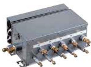
Für die Außeneinheit AMW-42U4SE wird die Verteilerbox F15E benötigt. Die kompakte Einheit verfügt über fünf elektronische Einspritzventile sowie deren elektrische Ansteuerung für den Anschluss von bis zu fünf Inneneinheiten der Serie Free Match. Eine integrierte Kondenswasserwanne mit Kondenswasserablaufstutzen führt durch Taupunktunterschreitung anfallendes Kondensat sicher ab.
