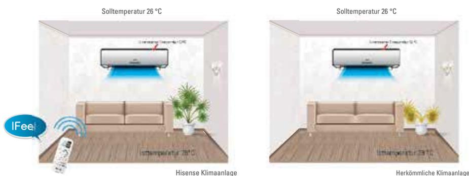
Temperaturrefassung an der Fernbedienung der Inneneinheit, zur individuellen Auswahl des Messpunktes.
